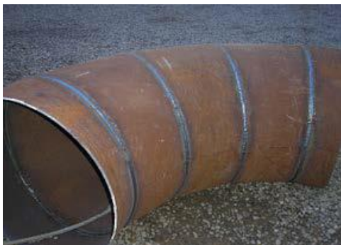
Fig. 5.2. Îmbinarea tuburilor de oțel prin sudare cap la cap
